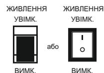
Це основний вимикач для стабілізатора. Якщо струм навантаження перевищить максимальний вихідний струм стабілізатора, вимикач автоматично вимкнеться. Перед повторним увімкненням зменшіть навантаження.
